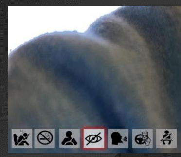
Obstrucción de cámara
